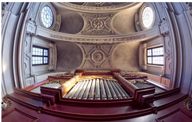
générale très habile pour faire entrer les 33 registres dans un espace relativement compté en raison du buffet historique à respecter. La traction des claviers est reconstruite à neuf et à nouveau mécanique, le tirage des registres est électrique et accouplé à un système de combinateur très performant (11 x 1000 combinaisons). On inaugure l'orgue reconstruit en 2010.
